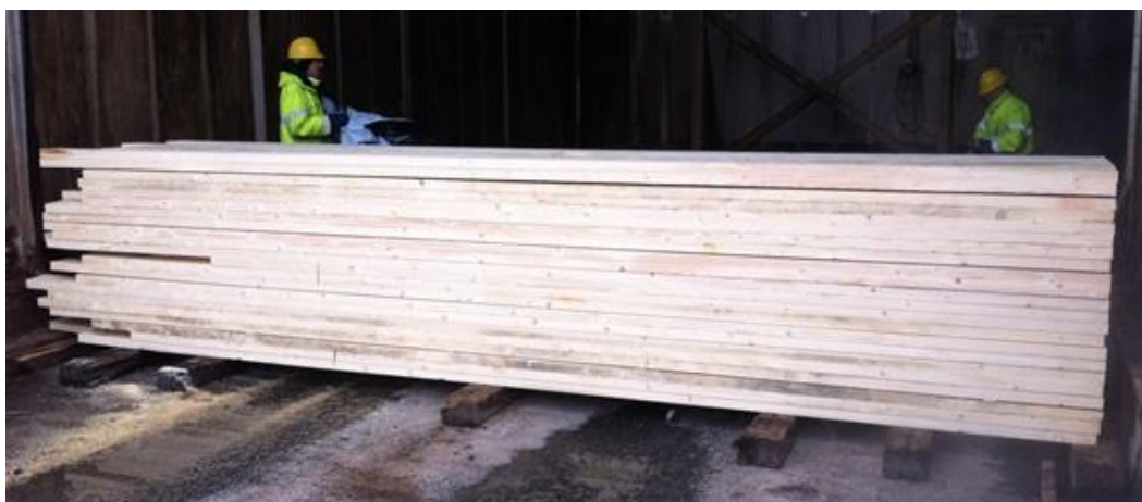
Figur 1. Paket 5 uppvisade kraftig mögelpåväxt efter lagring.
