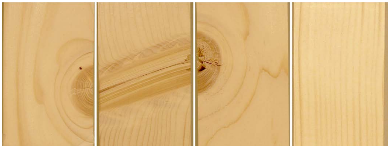
Figur 2.8 En kvist sedd från alla fyra sidorna av ett trästycke med kvadratisk tvärsnitt 45 \times 45 mm.
