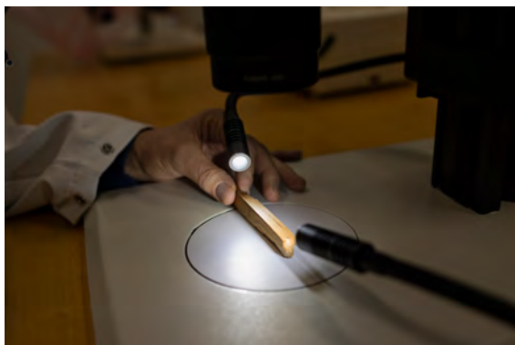
Provbiter analyseras i stereomikroskop.
