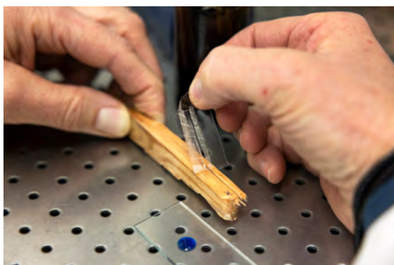
Provtagning för vidare analys med hjälp av tejpavtryck.
