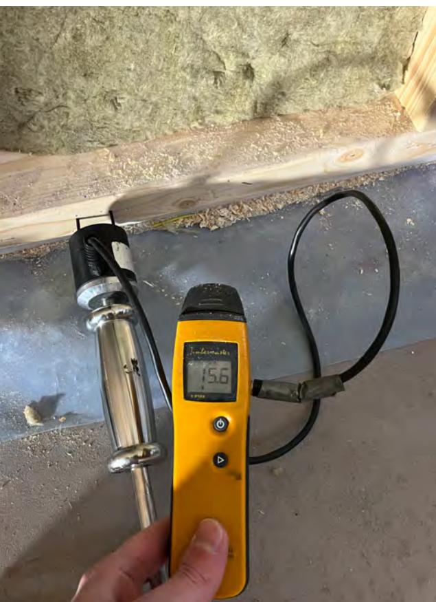
Mätning av fuktkvot.
