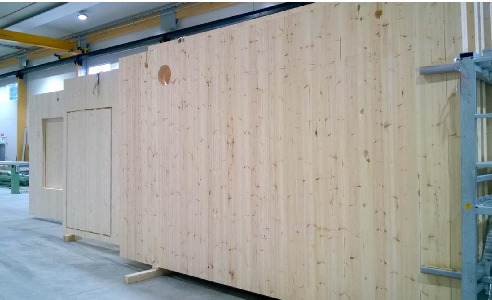
KL-träelement färdiga för paketering och leverans.
