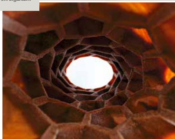
Formstudie utskrivet med en 3d-printer som laddats med sågspån blandat med ett organiskt bindemedel.
