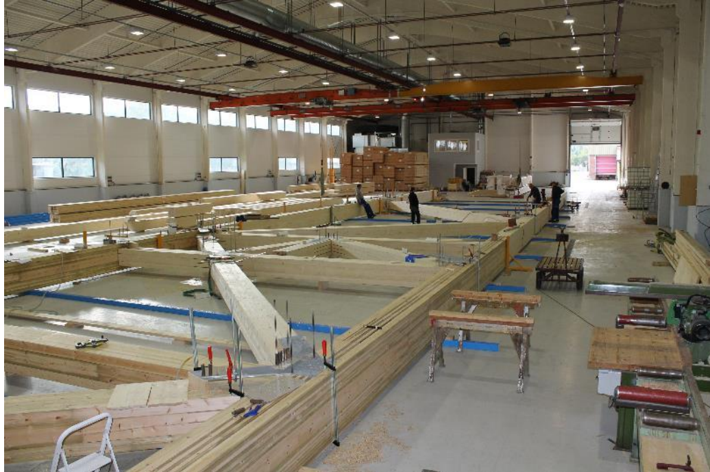
Utlekking av konstruksjon i fabrikk
