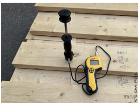
Foto som visar uppmätt fuktkvot i virkesstycket.
